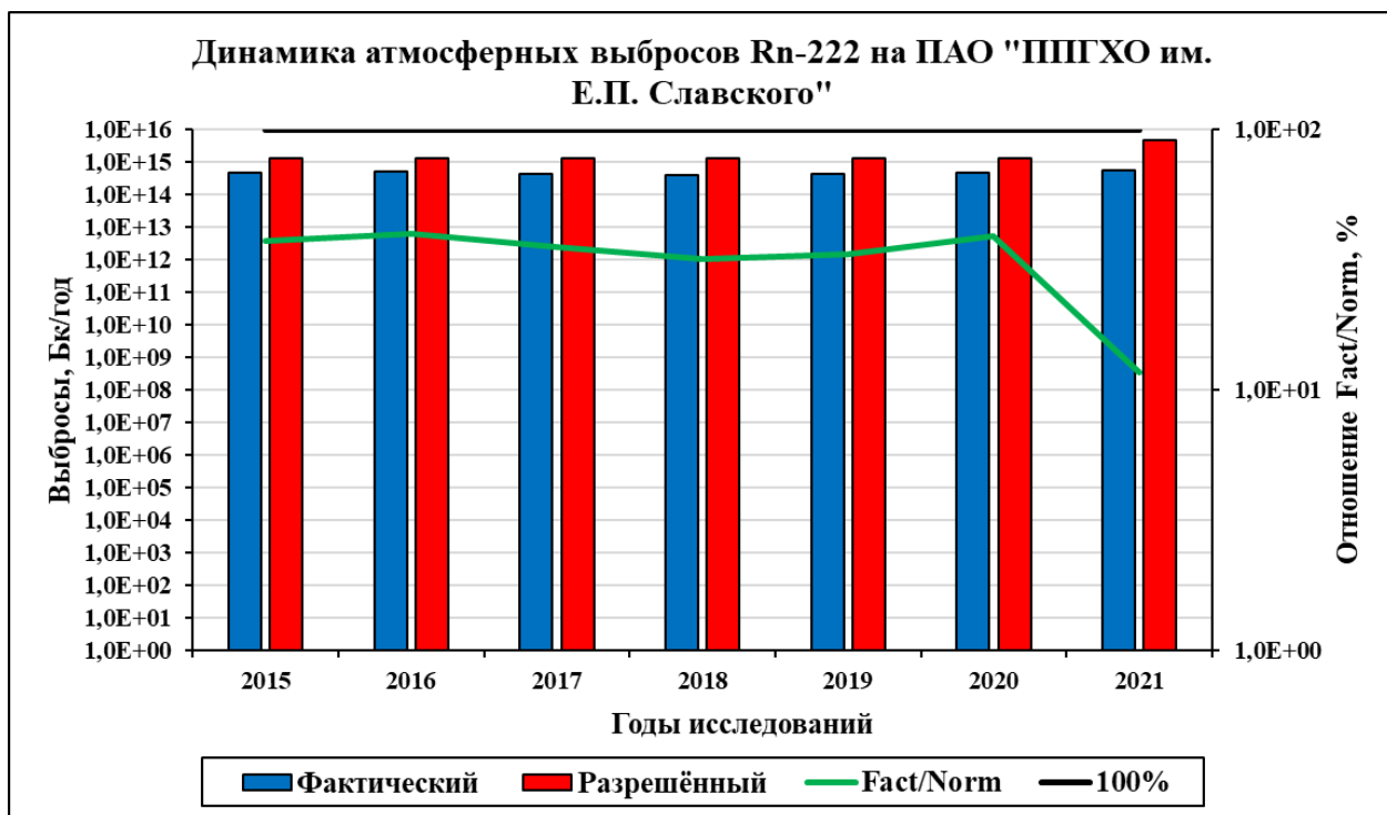
Рисунок Б.19 - Диаграмма атмосферных выбросов Rn-222 на ПАО «ППГХО им. Е.П. Славского» за 2015-2021 гг.
