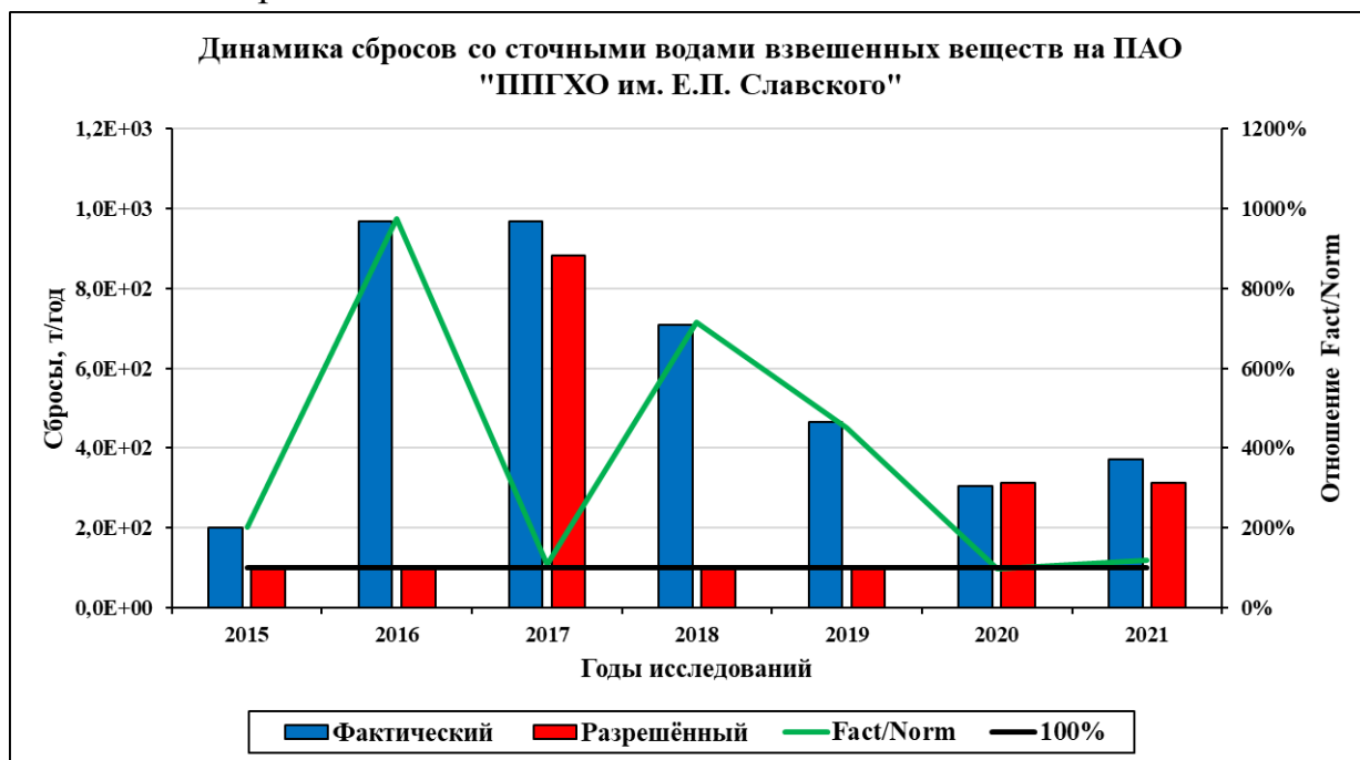
Рисунок Б.1- Диаграмма сбросов со сточными водами взвешенных веществ на ПАО «ППГХО им. Е.П. Славского» за 2015-2021 гг.
