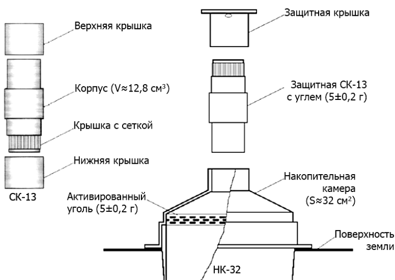
а) схема сборки накопительной камеры НК-32 и сорбционной колонки СК-13
