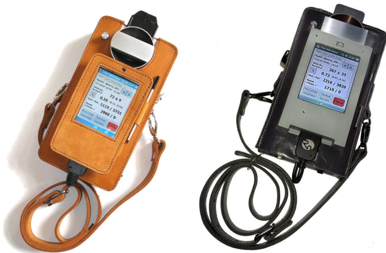
Рисунок 2.1.3 – Альфа-радиометр РАА-20П2 «Поиск» (исходная и модернизированная версии) [Фото с сайта НТЦ «Нитон», https://niton.su ]
