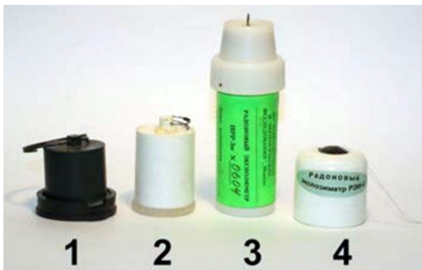
Рисунок 2.1.10 – Основные типы трековых пробоотборных камер, использовавшиеся в России. Разработаны: 1 – Санкт-Петербургским научно-исследовательским институтом радиационной гигиены им. П.В. Рамзаева; 2 – Радиевым институтом им. В.Г. Хлопина, Санкт-Петербург; 3 и 4 – АОЗТ «Радиационные и экологические исследования», Москва (в настоящее время – ООО «ГК РЭИ»)
