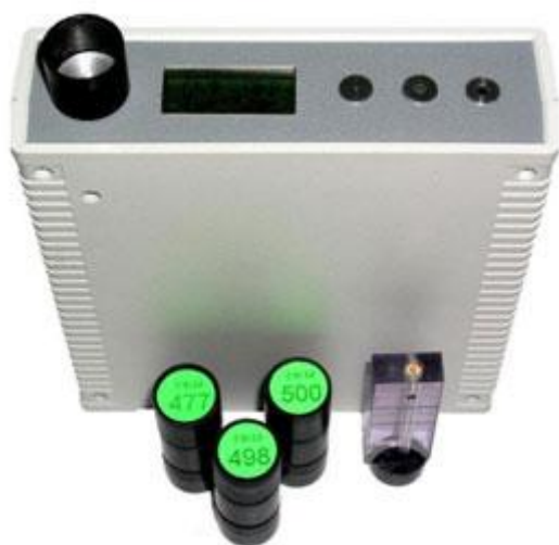
Рисунок 2.1.8 – Вспомогательное оборудование комплекса «КАМЕРА-01»: a) воздухоотборное устройство для мгновенного измерения ОА радона в ВОЗДУХЕ [Фото с сайта НТЦ «Нитон», https://niton.su ]; б) накопительная камера для измерения ППР
