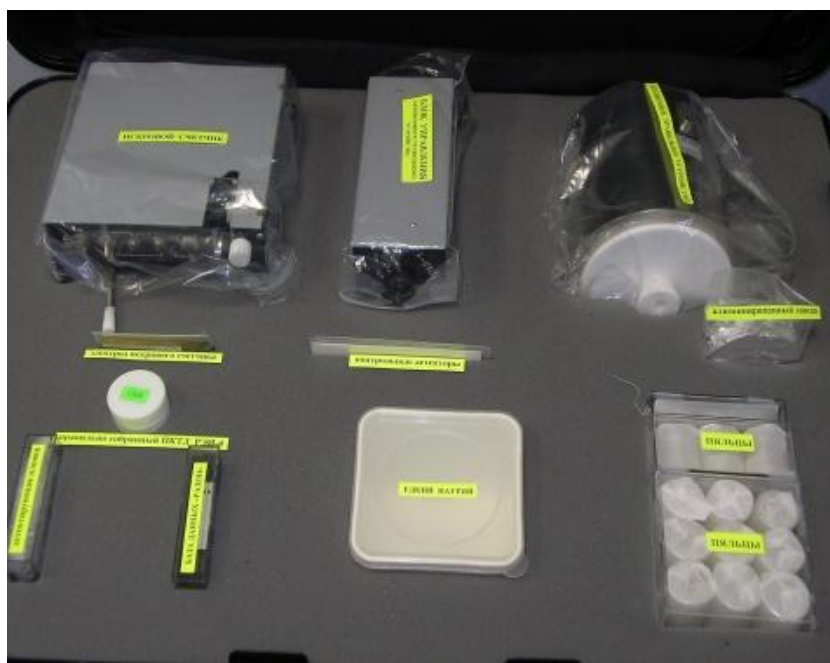
Рисунок 2.1.12 – Комплект аппаратуры для измерения средней объемной активности радона в воздухе трековым методом ТРЕК-РЭИ-1М [ГК РЭИ]
