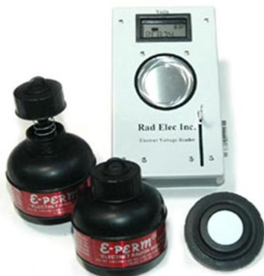
Рисунок 2.1.15 – Электретный комплект «E-PERM» [Rad Elec Inc.]
