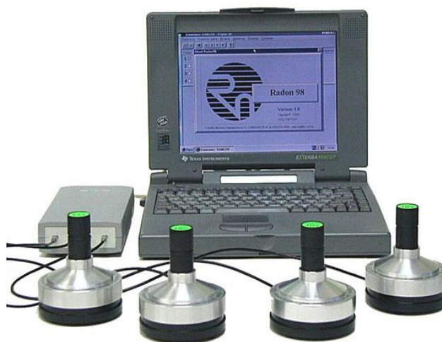
Рисунок 2.1.7 – Радиометрическая установка для измерений активности ДПР радона в активированном угле по бета-излучению (коммутатор МК-4 и четыре блока детектирования БДБ-13) [Фото с сайта НТЦ «Нитон», https://niton.su ]
