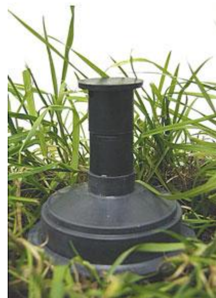
б) накопительная камера НК-32 в сборе с сорбционной колонкой СК-13, установленная на грунте
