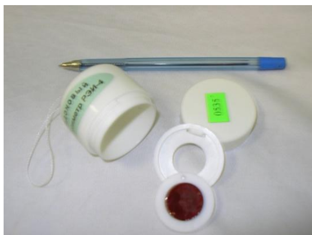
Рисунок 2.1.13 – Пробоотборная камера РЭИ-4 (в разобранном виде) [ГК РЭИ]
