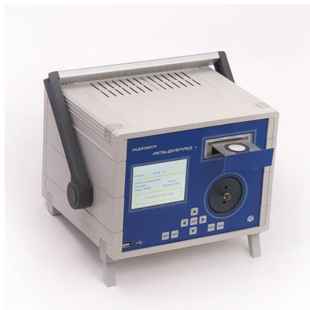
Рисунок 2.1.1 – Комплекс измерительный для мониторинга радона, торона и их дочерних продуктов «Альфарад плюс»: а) модификация А; б) модификация АР
