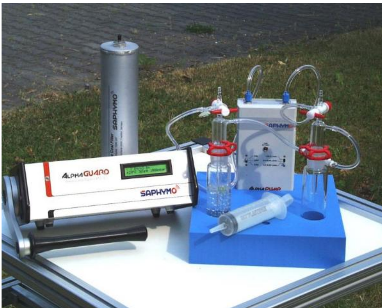
Рисунок 2.1.21 – Измерение УА радона в воде при помощи радиометра AlphaGUARD PQ2000/PQ2000PRO с воздуходувкой AlphaPUMP и комплектом вспомогательного оборудования AquaKIT [SAPHYMO]
