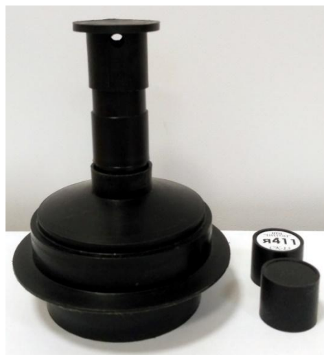
Рисунок 2.1.8 – Вспомогательное оборудование комплекса «КАМЕРА-01»: a) воздухоотборное устройство для мгновенного измерения ОА радона в ВОЗДУХЕ [Фото с сайта НТЦ «Нитон», https://niton.su ]; б) накопительная камера для измерения ППР
