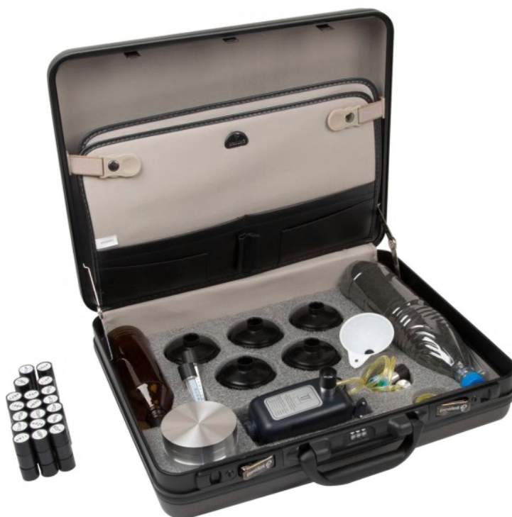
Рисунок 2.1.9 – Комплект оборудования для определения содержания радона [НПП «Доза»] или Комплект оборудования для мониторинга радона [НТЦ «Амплитуда»]
