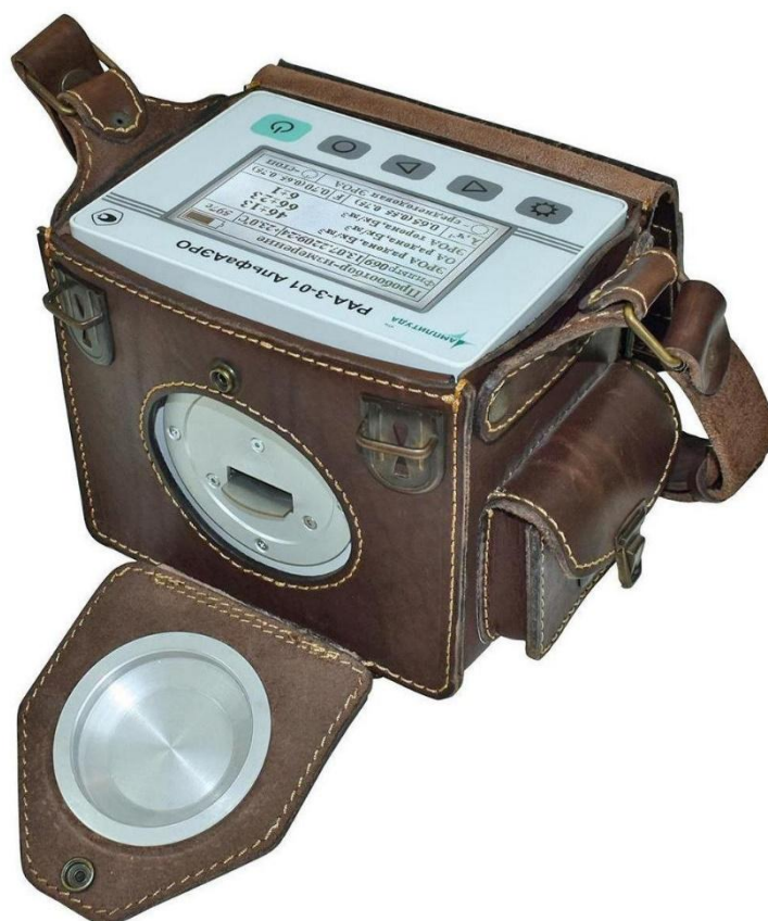
Рисунок 2.1.4 – Альфа-радиометр радона аэрозольный РАА-3-01 «АльфаАЭРО» [Фото с сайта ООО «НТЦ Амплитуда», https://amplituda.ru ]
